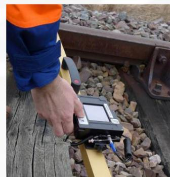
erkannt und angezeigt. Unmittelbar nach Abschluss der Messung liegen sämtliche Messwerte fertig ausgewertet und in digitaler Form vor. Die zentralen Funktionskomponenten des MessReg PTP II sind das digitale Basismessgerät (DBM-2) in Verbindung mit dem speziell für Außeneinätze entwickelten Messcomputer (MPCe). Der Datenaustausch des Messsystems mit der übergeordneten Anwender-Software erfolgt per SD-Speicherkarte.
